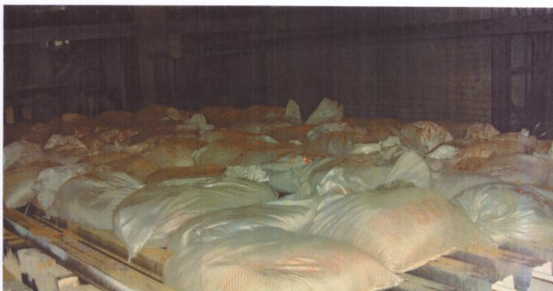
Рис. 2. Опытный образец № 1 с приложенной равномерно-распределенной нагрузкой.
